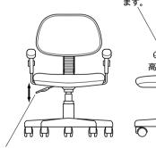
・レバーを引き上げると座面の高さ 調節ができます。イスに座ってな い状態で引き上げると座面が上昇 し、イスに座った状態で引き上げ ると座面が下降します。
