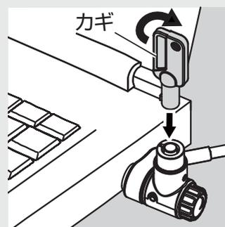
①付属のカギを差し込みながら矢印方向に回して開錠し、元に戻してカギを抜きます。
