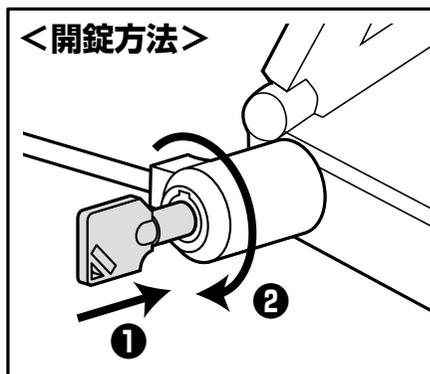
鍵を錠の穴に合わせて差し、押し込みながら時計回りに約90°回転し、開錠します。
