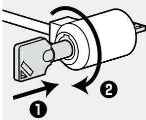
(2)鍵を錠の穴に合わせて差し、押し込みながら時計回りに約90°回転し、開錠します。
