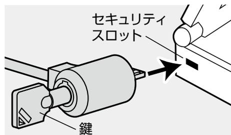
(3)ノートパソコンなどのセキュリティスロットに錠の先端を差込んで、鍵を抜きます。
