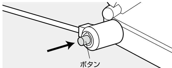
(4)ボタンを押し込むと施錠されます。※先端部分を奥まで差し込んだ状態の場合、ボタンが押しづらい場合があります。その場合は少し手前に引いた状態でボタンを押ししてください。
