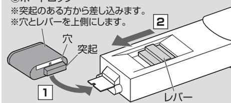
レバーを手前にした状態で、ポートロックを上図の向きで取付け器具の先端に取付け、レバーを先端側にスライドしてロックしてください。
