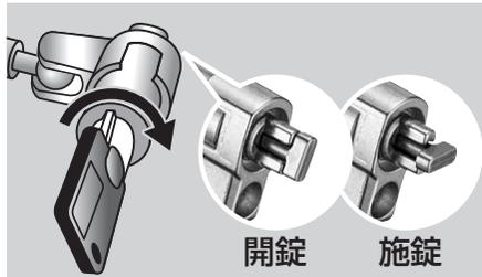
① 鍵を錠の穴に合わせて差込み、押し込みながら右回りに90°回転し、開錠してください。先端部分が平行になります。
