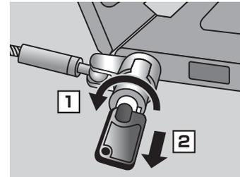
③ 鍵を押し込みながら左回りに90°回転して抜き取ると、本体がスロットにロックされます。
