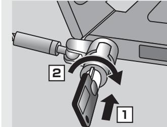
鍵を錠の穴に合わせて差込み、右回りに回転すれば開錠されます。鍵を差したまま抜き取ってください。
