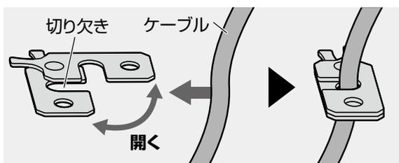
① 本製品を開き、上図のように切り欠きにマウスやテンキーなどのケーブル(φ5.5mmまで対応)を取付けてはさみます。
