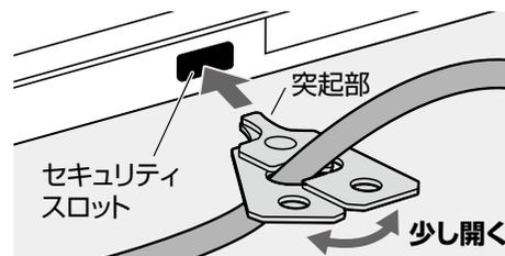
② 上図のように突起部の形が合うよう本製品を少し開き、ノートパソコンなどのセキュリティスロットに差し込みます。
