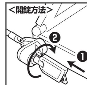
錠を錠の穴に差し、押し込みながら右回りに回転し、開錠します。鍵を元の向きに戻せば抜き取ることができます。
