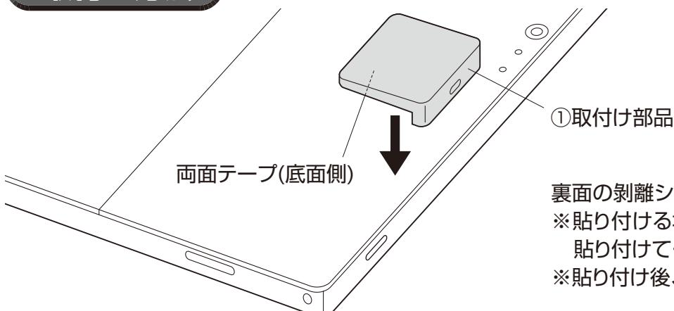
裏面の剥離シートをはがして貼り付けます。
