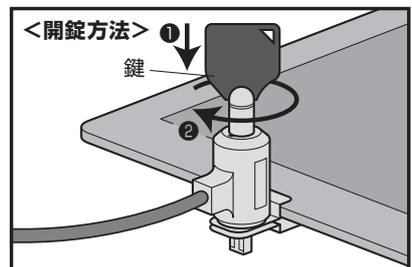
錠を錠の穴に合わせて、押し込みながら矢印の方向に回すと開錠されます。
