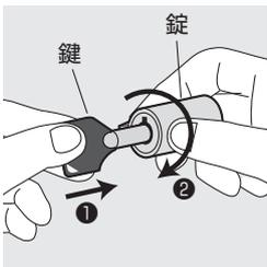
① 鍵を錠の穴に合わせて差し込み押し込みながら矢印の方向に回転し、開錠します。
