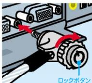
①図のように本体を回してコネクタのネジに取付けます。その際、ロックボタンは押さないようにしてください。
