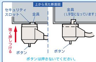
ノートパソコンのセキュリティスロットへ本体の錠の金具を押し込みます。
