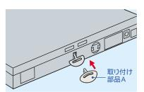
マイクロロックの取り付け部品Aを部品Bに かぶせます。
