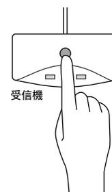
キーボードを受信機に近づけ受信機の上のボタンを押して5秒以内にキーボード上の「Connection」ボタンを押します。
