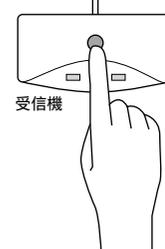
マウスを受信機に近づけ受信機の上のボタンを押して5秒以内にマウスの裏の「RESET」ボタンを押します。
