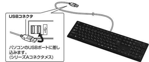
パソコンのUSBポートに差し込みます。(シリウスAコネクタ専用)
