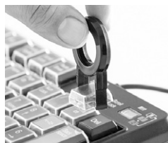
付属の工具でカバーの取外し簡単
