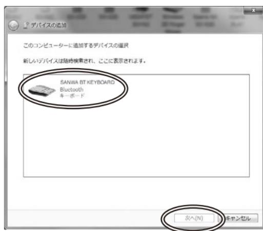
5. ペアリングが完了した後、「Fn」 + 「Q(Win、Android)」のキーを同時に押し、Windows の配列に変更してください。
