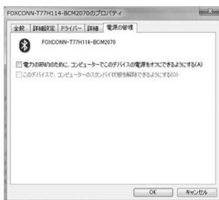
3. 「電源の管理」タブをクリックし、その中にある「電力の節約のために、コンピューターでのデバイスの電源をオフにできるようにする」の項目のチェックを外します。
