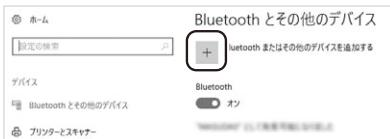
4.本製品の電源をONにします。「Fn」+「F2」キーを同時に押してペアリングを開始します。ペアリングLEDが点滅します。
