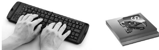
キーピッチが標準キーボードと同じサイズで、ノートパソコンと同じ軽いタッチが可能なパンタグラフタイプです。キーの下に鉄板を敷いているため、確実な入力感が得られます。
