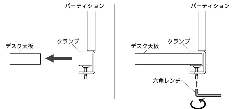
デスク天板をクランプではさみ、六角レンチでボルトを回し確実にしめて固定します。
