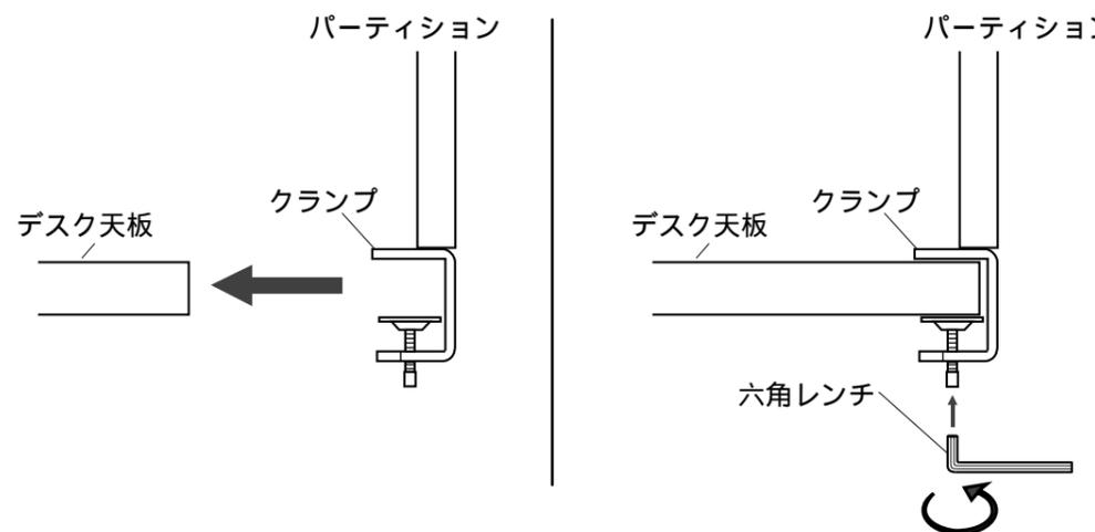
デスク天板をクランプではさみ、六角レンチでボルトを回し確実にしめて固定します。
