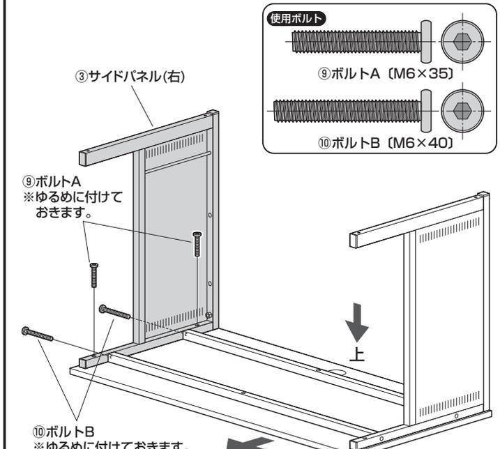
**4** サイドパネルにバックパネルを取付けます。
