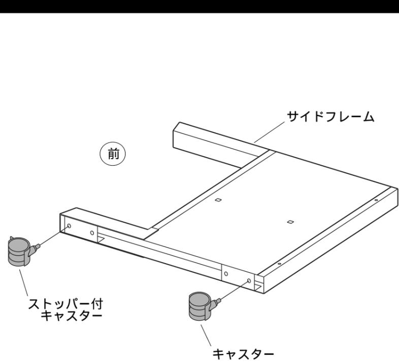
2 サイドフレームのナットにボルト A をねじ込みます。
