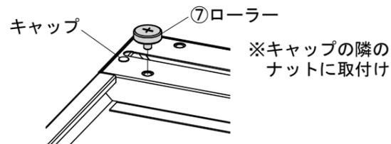
※キャップの隣のナットに取付け
