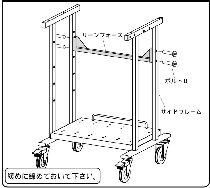
**4** サイドフレームにバッテリートレイをボルトAで緩めに取付けます。ケーブルはケーブルストラップを使いまとめて固定できます。
