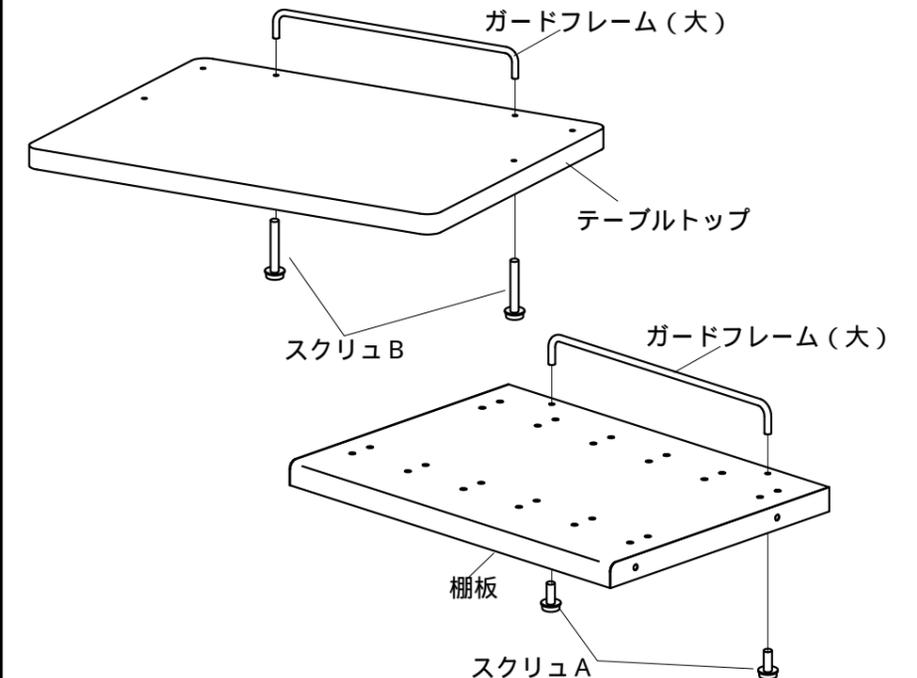
2 サイドフレームに棚板をボルト A で緩めに取付けます。
