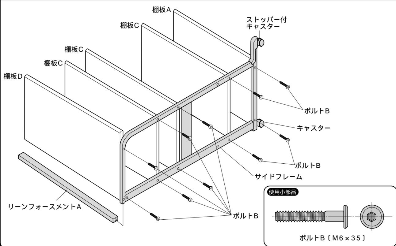
2 サイドフレームにリーンフォースメントBをボルトAでゆるめに取り付けます。
