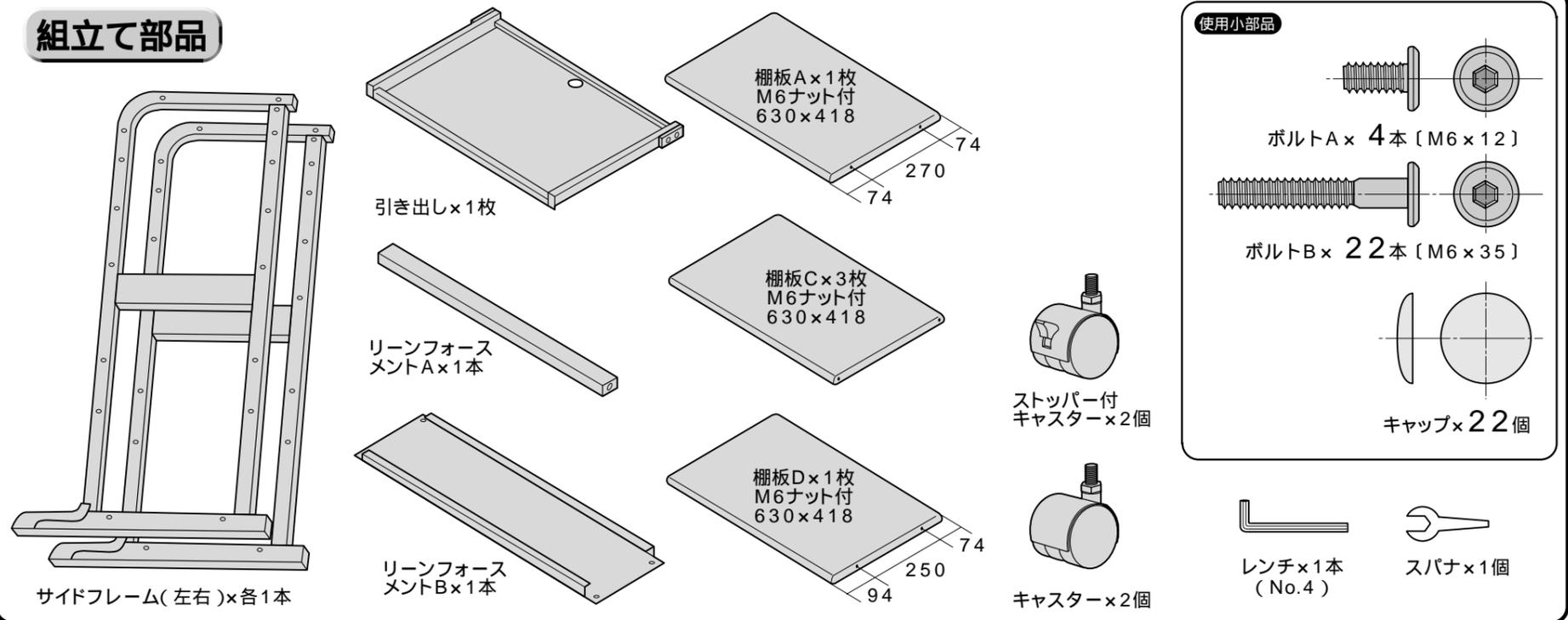
1 サイドフレームに棚板A・C・Dと、リーンフォースメントAをボルトBでゆるめに取り付けます。前側にストッパー付きキャスターがくるようにキャスターをスパナで取り付けます。
