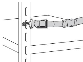
(3) ベルト端部を引いて、緩まないように調整します。
