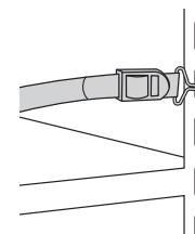
(2) ベルトが平行になるように反対側柱の長穴部にフックを掛けます。
