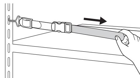
(4) ベルト端部が垂れながらないようにベルト通しに入れて固定します。
