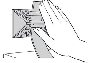
(4)もう片方の接着パッド付きベースも同じように貼り付けます。※対象物1個に対して2本の取付けを推奨しています。
