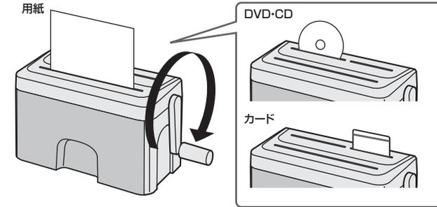
※用紙投入口(A4サイズ)より大きな紙を細断する場合は、投入口より小さい幅に折ってから細断を開始してください。(規定枚数を超えないようにしてください。2ツ折/1枚=2枚)
