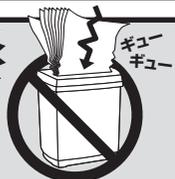
必ず定格細断枚数、規定素材、連続運転時間を
