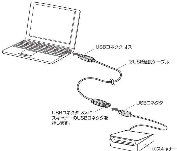
❗ 故障の原因になりますのでUSBケーブルを延長する際は必ず付属のUSB延長ケーブルを使用して接続してください。
