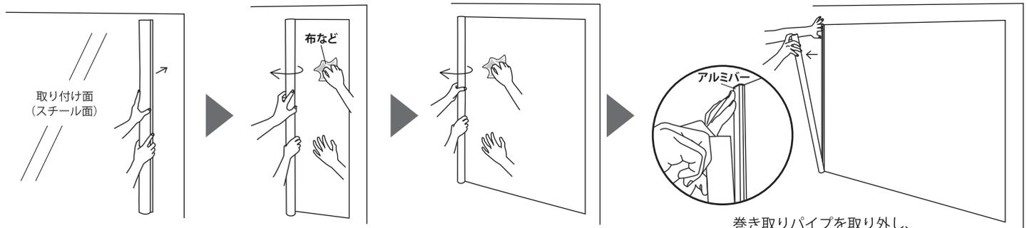
取り付け面に端から固定します。
