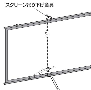
●スクリーン吊り下げ金具で三脚(別売)に吊り下げて使用できます。
