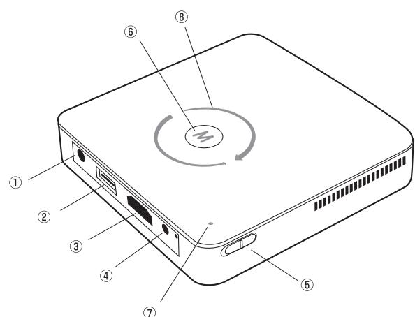
①3.5mmステレオミニジャック(音声出力)
