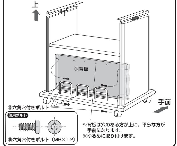
**7** ロッドを差し込み、ブックスタンドを取り付けます。その後、ゆるめておいたボルトを締めつけます。
