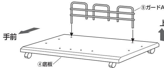
②底板の裏からプラスボルトBで固定します。
