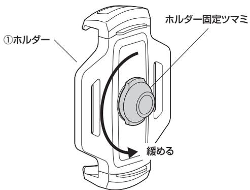
②クランプアームのボールジョイントにホルダー固定ツマミを差し込みます。
