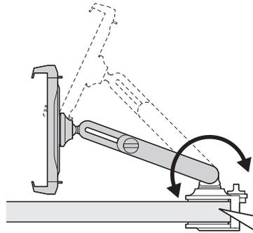
下アームの動きが軽すぎたり、重すぎる場合は六角レンチ (3mm) でクランプ内のネジ (中央) を回して調節します。
