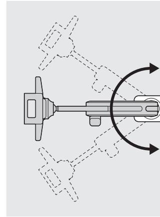
アームの動きが軽すぎたり、重すぎる場合は六角レンチ (2.5mm) でクランプ内のネジ (3ヶ所) を回して調節します。
