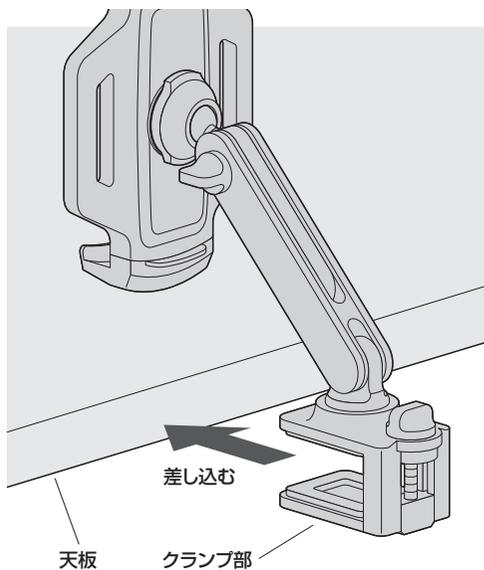
②クランプ固定ツマミを締め付けます。
