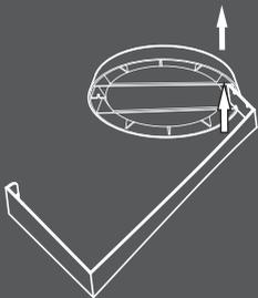
② シリコントレイを矢印の方向へ下ろし、フレームに取付けます。
