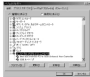
これはUSBインターフェースの正常な動作状況です。USBデバイスアイコン(「Host Controller」や「USBルートハブ」)に「！」や「？」マークが表示されていたり、または「ユニバーサルシリアルバスコントローラ」のデバイスがなにも見つからない場合、マザーボードのBIOSをアップグレードしたり、BIOS設定を確認してください。
