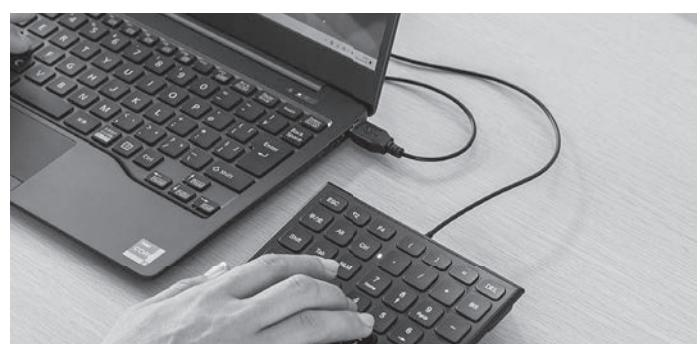
パソコンの機種によっては、サスペンドモード(スリープモード・スタンバイモード)後にUSBテンキーを認識しない場合があります。この時は接続しているUSBコネクタをいったん引き抜いてからもう一度接続し直してください。
