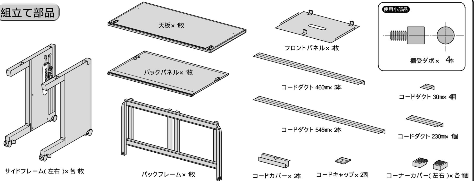
1 サイドフレームにバックフレームを取り付けます。
