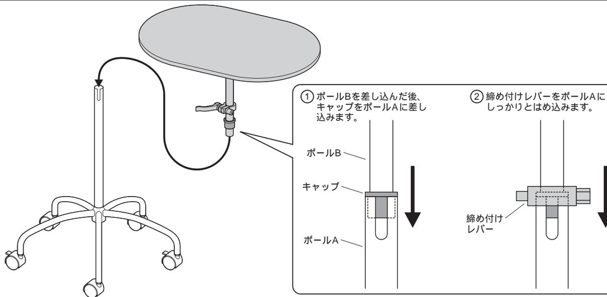
7 締め付けレバーで固定して完成です。
