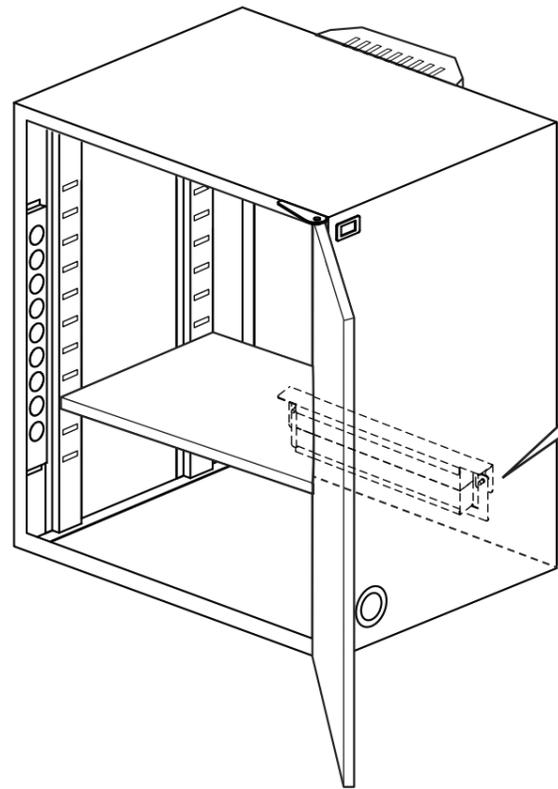
本体の外側よりネジを2ヶ所緩め、ダンパーを上へ開け、ケーブル配線をします。
