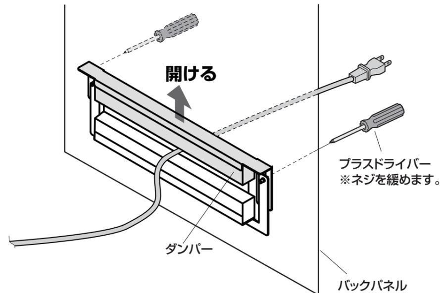
ケーブル配線後、隙間があかないようにダンパーを下へ押さえながら閉じ、本体の外側よりネジを2ヶ所を締めます。
