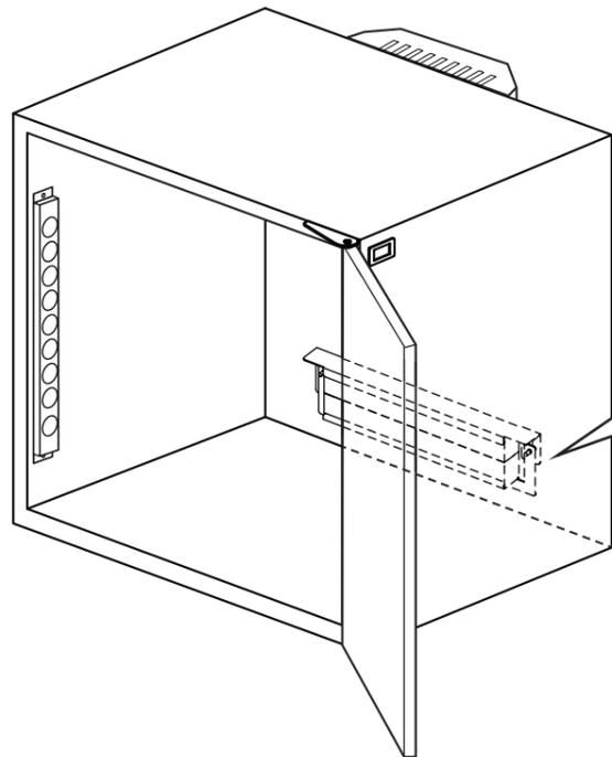
本体の外側よりネジを2ヶ所緩め、ダンパーを上へ開け、ケーブル配線をします。
