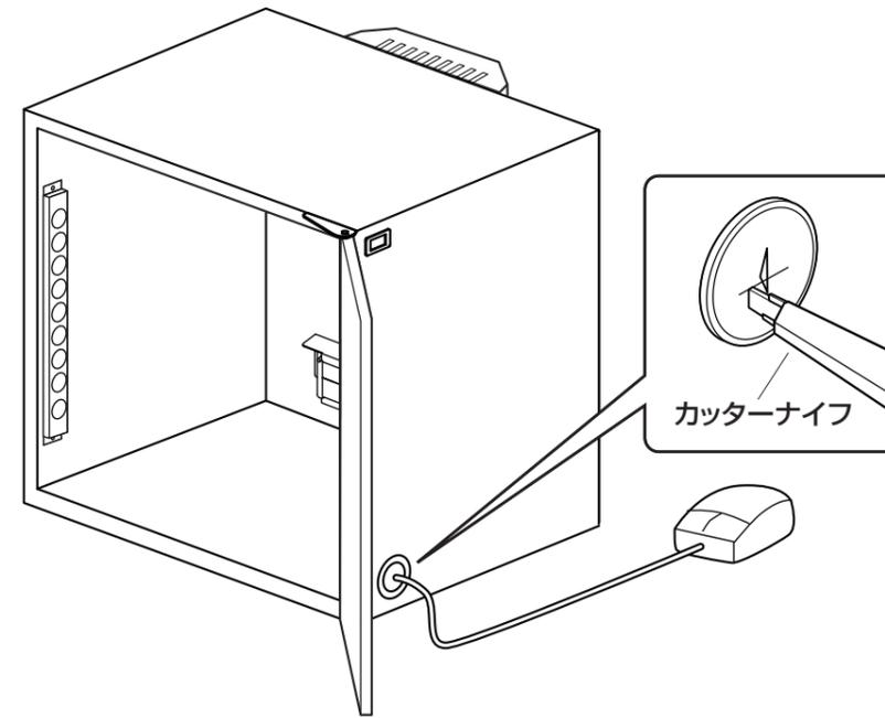
**手順 5** ケーブルの取出口からケーブル配線をします。
