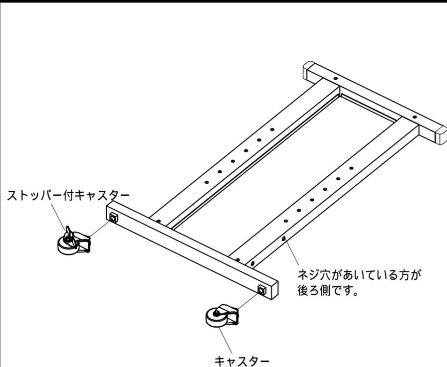
2 サイドフレームにリーンフォースメントをボルト C で緩めに組み付けます。
