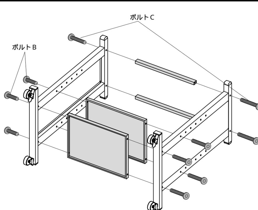
3 サイドフレーム背面にバックパネルをボルト A で取付けます。いままでに締めたボルトを締め直します。
