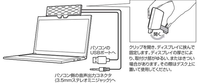
クリップを開き、ディスプレイに挟んで固定します。ディスプレイの厚さにより、取付け部がゆるい、またはきつい場合があります。その際はデスク上に置いて使用してください。
