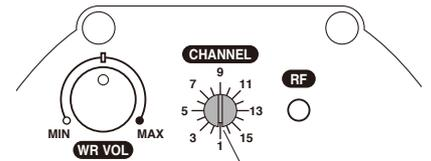
スピーカー本体(MM-SPAMP3)のチャンネル選択の凹みを付属のマイナスドライバーで合わせて設定します。
