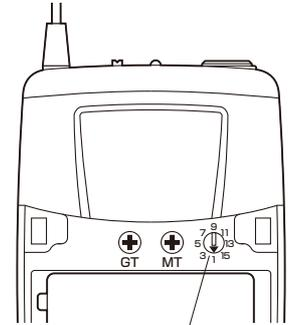
ワイヤレスヘッドマイク(本製品)送信機のチャンネル選択の三角の向きを付属のマイナスドライバーで合わせて設定します。
