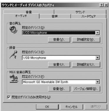
④ [音の再生]と[録音]の「規定デバイス」からそれぞれ「USB Microphone」を選択します。※この時、それぞれの[音量(V)] [音量(Q)]をクリックして、音量とミュート(消音)にチェックが入っていないかも確認してください。
