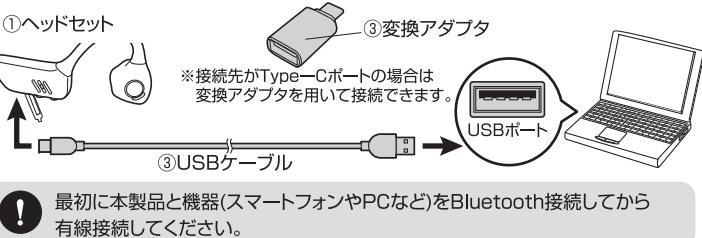
※接続先がType-Cポートの場合は変換アダプタを用いて接続できます。
