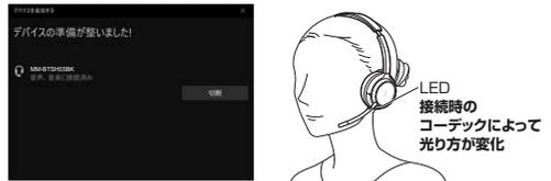
LED接続時のコーデックによって光り方が変化
