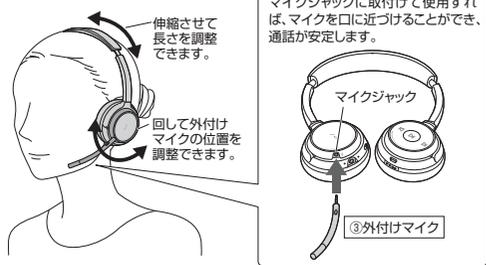
付属の外付けマイクをヘッドセットのマイクジャックに取付けて使用すれば、マイクを口付近に近づけることができ、通話が安定します。
