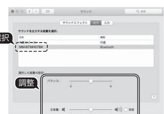
③「入力」から[MM-BTMH57BK]を選択し、音声入力の音量、バランスを調整してください。
