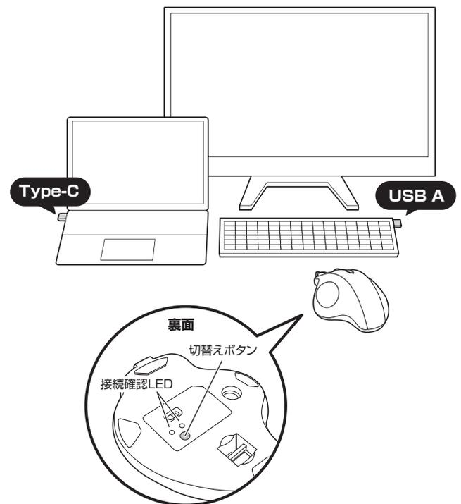
接続確認LEDで、接続されているデバイスを確認することができます。
